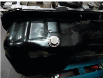
1. Démontez la vis endommagée du purgeur d'huile.
