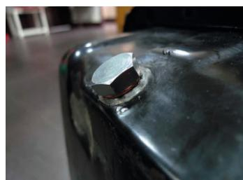
4. Placer une rondelle sur le nouvel écrou du purgeur d'huile et le visser dans le trou taraudé.
